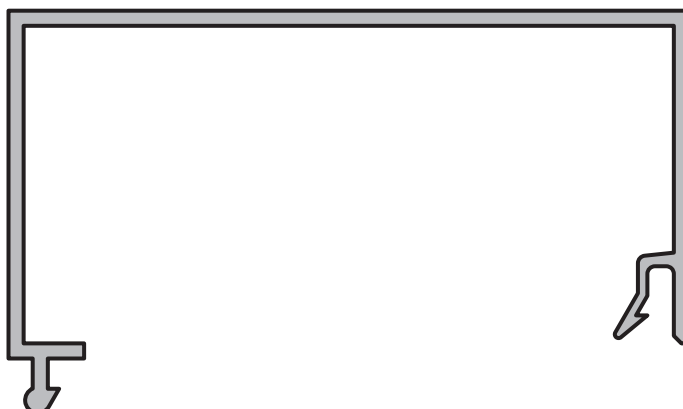
SEMITUBO PARA CUADRADO DE 90 x 90 mm. Perfil: 2719 Peso: 1,104 Kg/m
